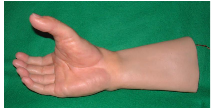
装飾用グローブを付けた電動ハンド（触覚センサ付き）
